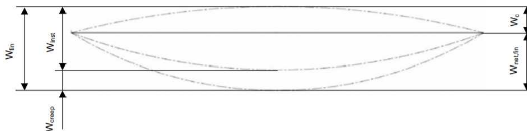
Schéma 2 : la flèche résultante finale ( W_{net,fin} ) est mesurée sous les appuis
