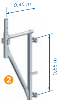
console de déport à colliers de 0,46 m 20.073 poids : 7,9 kg
