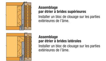
IMPORTANT : l'étrier ITB permet une installation sans renfort d'âme.
