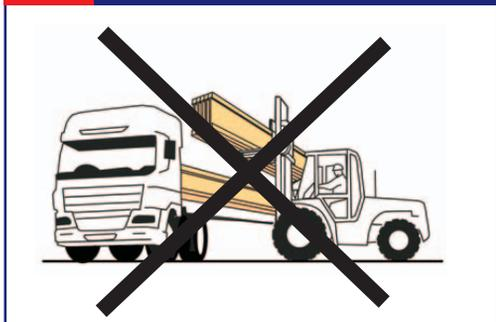
**NE PAS!** Soulever les Finnjoist dans le sens perpendiculaire à leur plan
