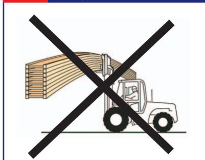
**NE PAS!** Soulever les Finnjoist par la membrure supérieure
