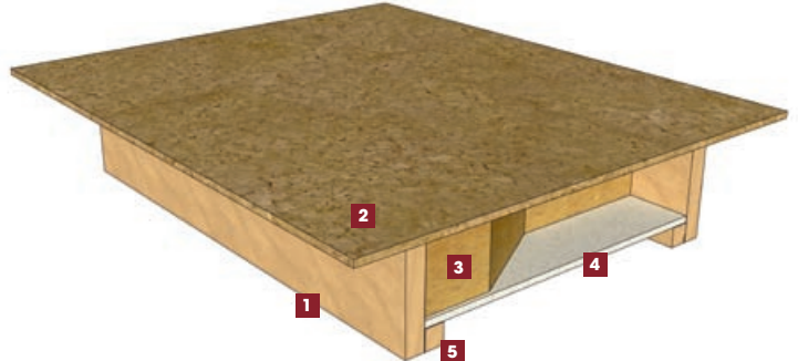
2.2 Plancher avec isolation et plafond entre solives
