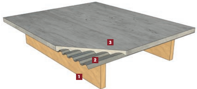
2.3 Plancher mixte bois béton
