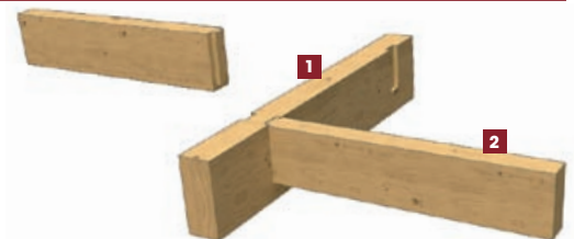
3.2 Assemblage à queue d'aronde
