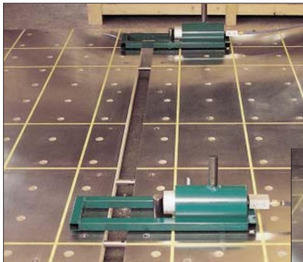
On raccorde les éléments soigneusement et précisément à l'aide des vérins pneumatiques. Comme dispositif on utilise un cadre simple qui est fixé à l'élément au moyen d'un boulon. De l'autre côté on met le vérin et le montage commence.
