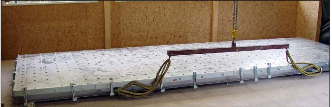
A cet effet les modules sont montés sur un châssis spécial qui garantit la stabilité et la précision de la table malgré de grands forces de torsion.
