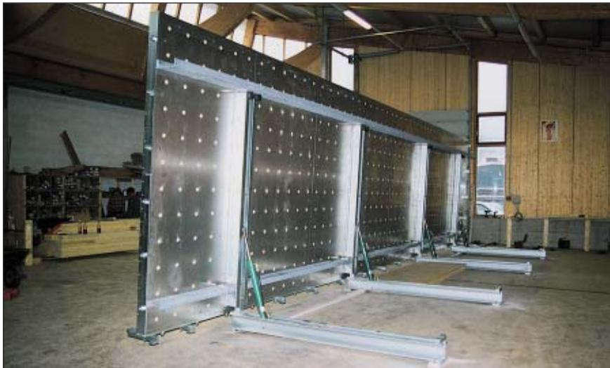
Avec l'inclinaison hydraulique, on réussit à mettre les ossatures à la verticale sans torsion. Ensuite ils se laissent facilement soulever avec une grue ou un pont roulant.
