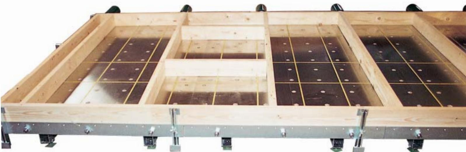
**Table de montage modulable, module de base de 1,5 x 3,0 m**
