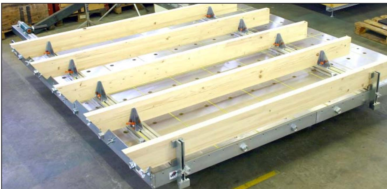
Deux rails spéciaux munis de butées réglables sont fixés sur la table à l'aide de la grille à trous. L'écart des butées réglables est défini une fois pour plusieurs ossatures.
