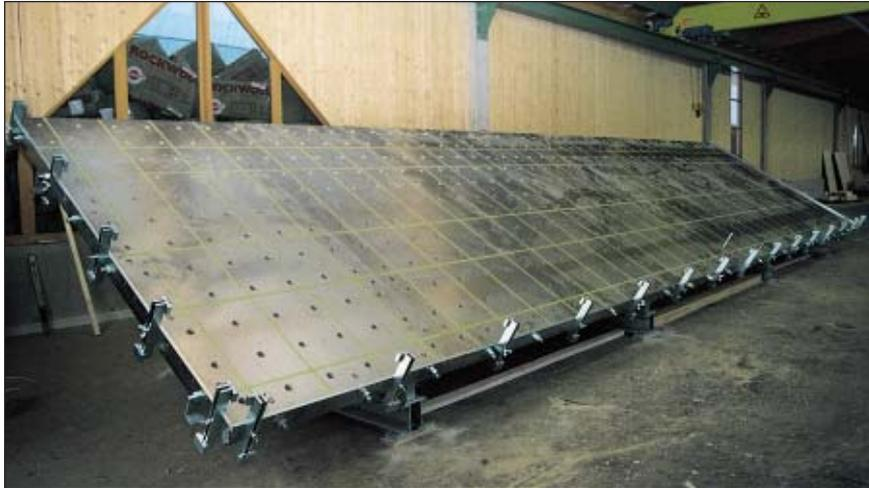
Grâce au système modulaire très flexible il y a la possibilité d'ajouter une inclinaison hydraulique à la table de montage. La charge utile de la table est de 140 kg/m<sup>2</sup> au minimum .
