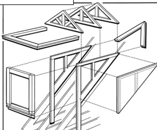
Lucarne fournie au candidat sous forme de composants et éléments préfabriqués comportant des ajustements éventuels à effectuer sur place
