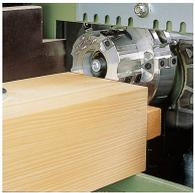
Que vous souhaitiez réaliser des tenons droits ou inclinés, la commande permet de travailler la pièce sur 4 faces en une passe. Ainsi, l'ensemble des tenons est chanfreiné sur le tenon en entier.
