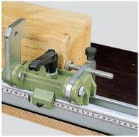
„Le profilé de butée de 3 mètres à graduation en mm et la butée en longueur permettent un positionnement précis des pièces à travailler”.
