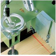
La nouvelle technique laser vous permet de positionner la pièce à travailler selon tracé.
