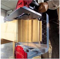
Grâce aux couples de rotation élevés, les Z 4 Ec et Z 5 Ec ne rencontrent pas la moindre difficulté dans le bois massif avec des profondeurs de coupe respective de 225 et 305 mm.
