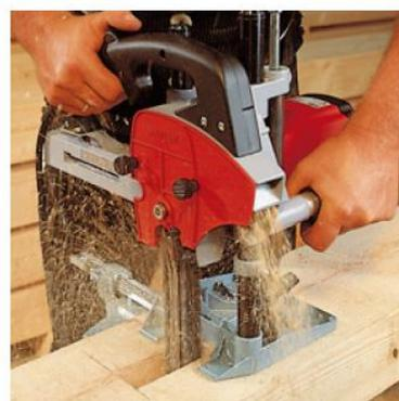
La LS 103 Ec et le support de guidage FG 150 pour des profondeurs de mortaises pouvant atteindre 140 mm.
