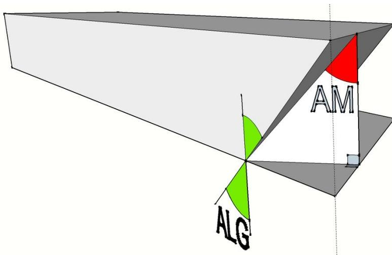
Pointer la machine sur l'angle machine (MCH) et suivre le tracé de l'angle aplomb (APL) sur la face de l'empannon. Le plan de coupe obtenu sur le chant coïncide normalement avec le tracé de l'angle alignement (ALG).
