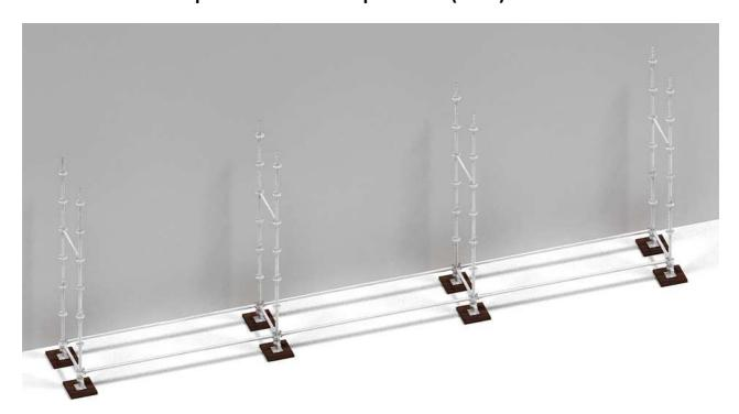
5. A partir au sol, mettre en place le premier niveau de planchers ainsi que les moyens d'accès (plancher à trappe) ne pas oublier les verrous de plancher. Installer le contreventement (diagonale). Positionner les longerons intérieurs (côté façade).
