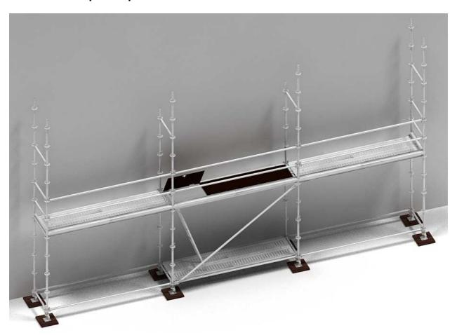
9. Mettre en place les planchers ainsi que les moyens d'accès (plancher à trappe) ne pas oublier les verrous de plancher. Positionner les longerons intérieurs (côté façade).
