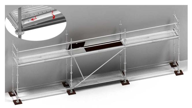
8. Continuer l'élévation de votre structure en respectant les étapes précédentes. Pour le niveau de terminaison, remplacer les poteaux 2m intérieurs par les poteaux de 1m.
