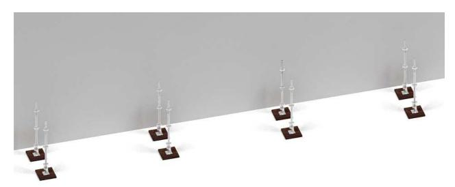
3. Relier les poteaux de départ à l'aide de longerons. Les aligner suivant l'implantation prévue et régler les vérins à vis pour assurer une horizontalité parfaite des longerons.
