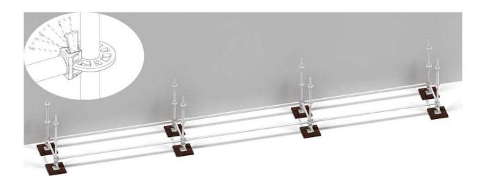
4. Elever la structure en positionnant les poteaux de 2m et les longerons qui accueilleront le prochain niveau de planchers (à 2m).
