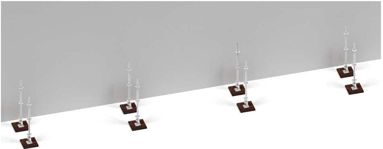
3. Relier les poteaux de départ à l'aide de longerons. Les aligner suivant l'implantation prévue et régler les vérins à vis pour assurer une horizontalité parfaite des longerons.
