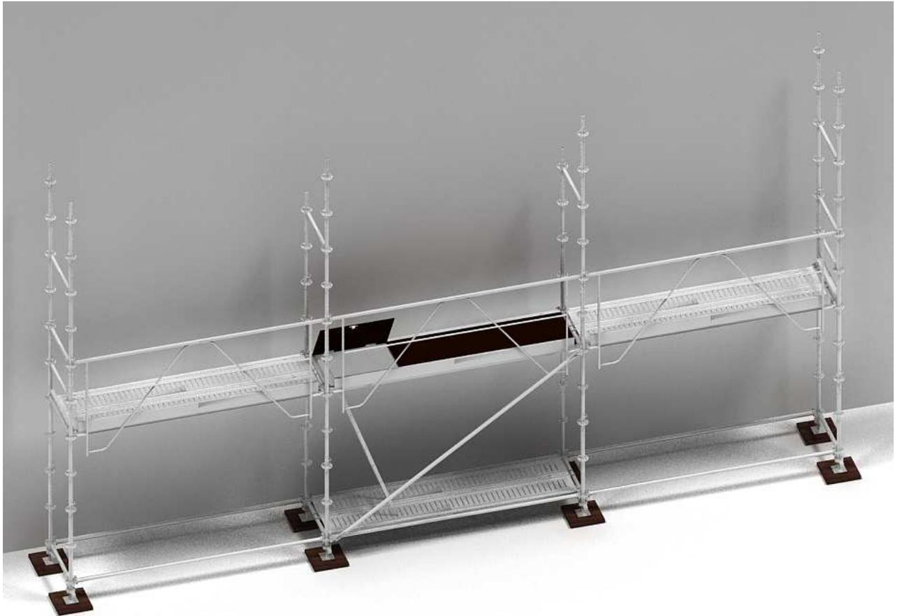
10. Positionner les garde-corps de face et les longerons intérieurs (côté façade). La maille réservée à l'accès doit avoir un 3<sup>ème</sup> longeron à 1.5m.
