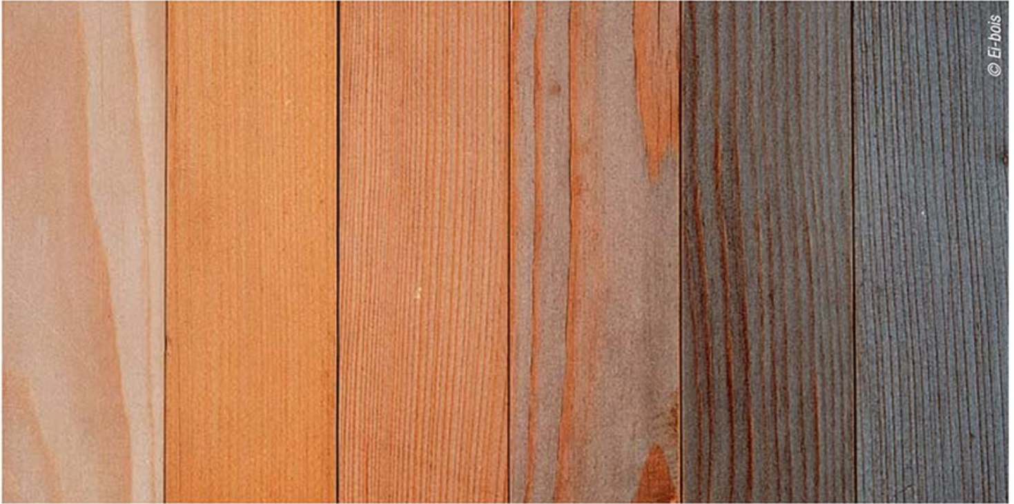
Influence du temps sur le type et l'intensité de l'altération due aux intempéries et sur la coloration du bois d'épicéa : d'une surface neuve, à gauche, à une autre fortement exposée à l'extérieur pendant 180 jours avec une orientation au sud et une inclinaison de 45°, à droite (Ei-bois).
