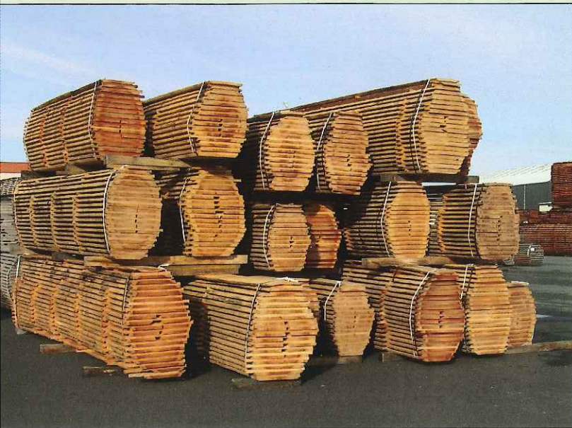
Après sciage, les billes sont reconstituées et soumises à un séchage naturel
