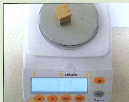
6 Balance précise à 0,01 g permettant de peser à 0,5 % près
