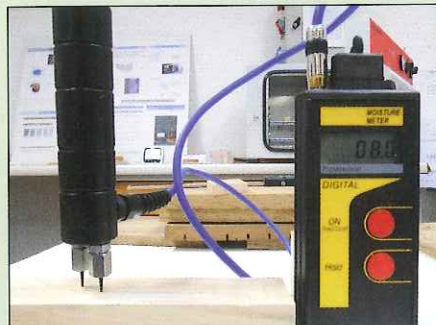
7 Mesure électrique, avec humidimètre
