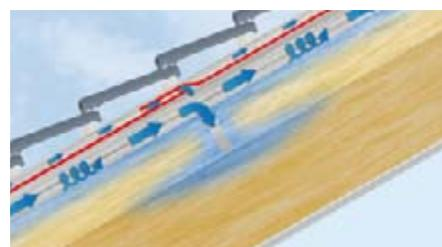
En toiture: écran de sous-toiture ventilé en sous-face, recouvrements à sec. Pénétration d'air froid dans l'isolant.
