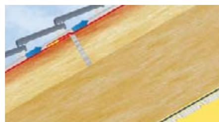
En toiture: écran de sous-toiture H.P.V. au contact direct de l'isolant, recouvrements collés. Pas de mouvements d'air parasites dans l'isolant.
