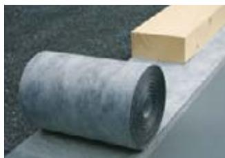
Bande d'arase tri couches d'épaisseur 1,2 mm, composée de 2 non tissés de protection combinés à une enduction spéciale format barrière aux remontées capillaires.
