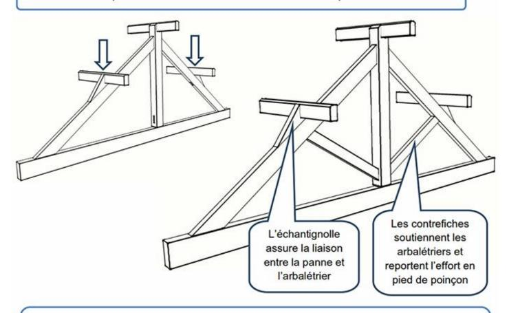
Lors de la mise en charge de la toiture, le poinçon peut descendre légèrement. Pour éviter d'induire une contrainte de flexion dans l'entrait, on laisse un jeu fonctionnel d'un centimètre entre le bas du poinçon et l'entrait. L'assemblage avec l'entrait est à tenon-mortaise non chevillé.
