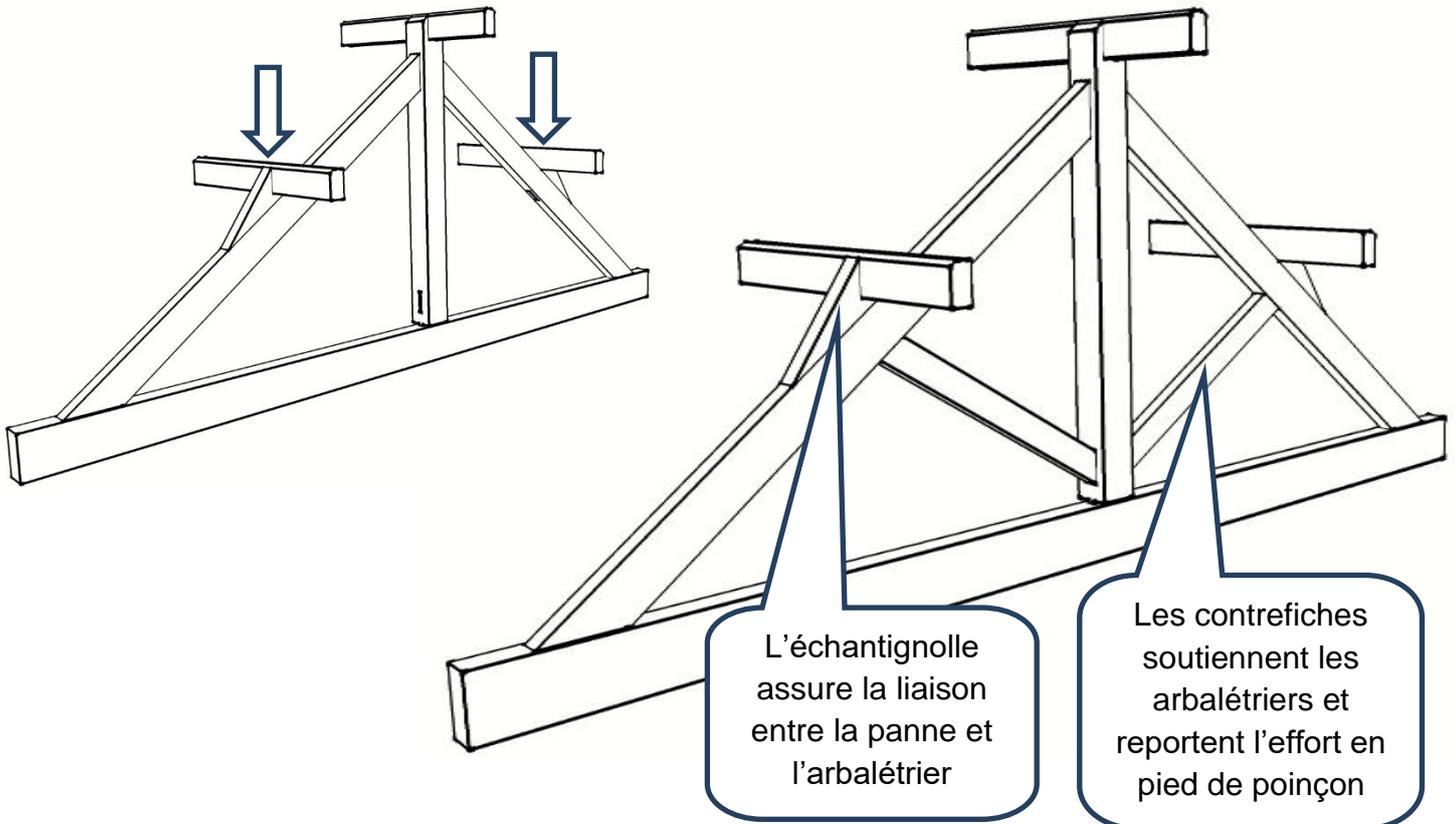
Lors de la mise en charge de la toiture, le poinçon peut descendre légèrement. Pour éviter d'induire une **contrainte de flexion** dans l'entrait, on laisse un jeu fonctionnel d'un centimètre entre le bas du poinçon et l'entrait. L'assemblage avec l'entrait est à tenon-mortaise non chevillé.
