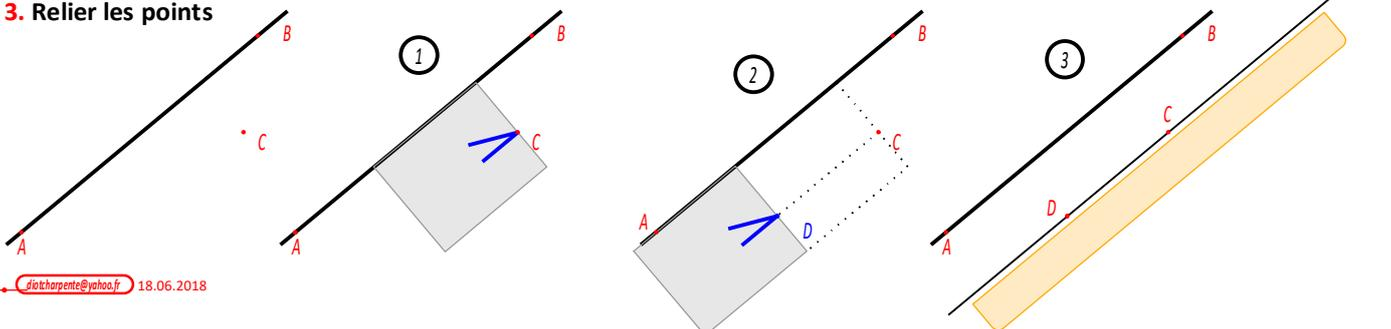
**1:** En faisant glisser une équerre sur une règle, tirer des parallèles à (QP) passant par .A et .B
