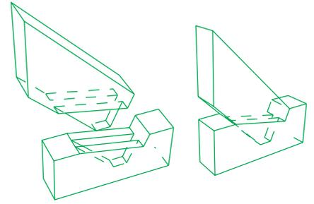
**1:** Tracer le tenon et la mortaise vue de face de l'assemblage.
