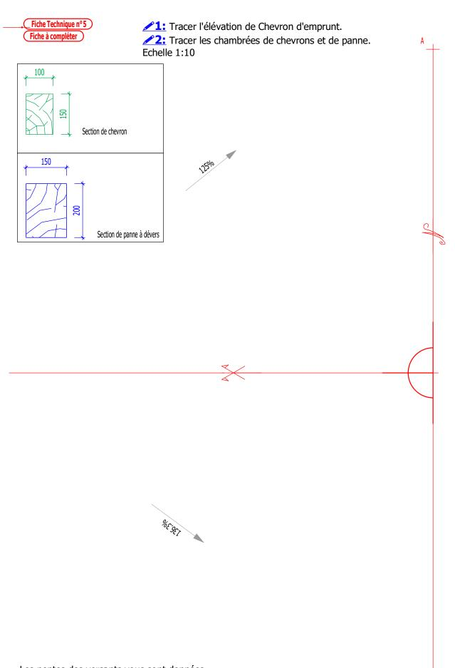
Les pentes des versants vous sont données. L'emplacement de la ligne de trave et de la ligne d'axe est également défini. Le versant à 136,4% passe par le point B, le versant à 125% passe par le point A.
